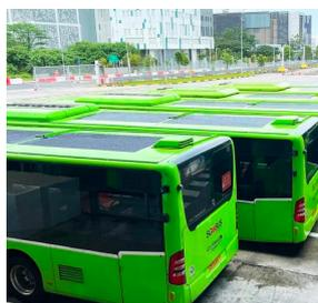
Instalar **paneles solares en buses eléctricos** (como en el caso del operador público Go-Ahead en [Singapur](#))
